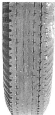
Um einen normalen und gleichmässigen Verschleiss der Reifen zu erhalten und dadurch deren Lebensdauer zu erhöhen, ist es erforderlich, die Vorderreifen in den **festgelegten Zeitabständen** mit den Hinterreifen auszutauschen und dabei auch das Ersatzrad einzubeziehen.
