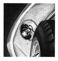
Si esegue operando dall'interno vano ruota e rimuovendo nell'ordine:
