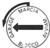
Pour verrouiller la direction tourner la clé à la position **BLOCCO** (Stop). Retirer la clé et manoeuvrer légèrement le volant dans les deux sens pour que le verrou rentre dans son logement.
