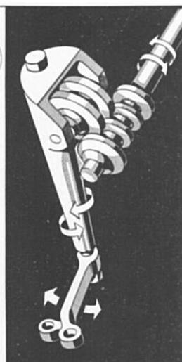
Les articulations à rotules de la timonerie de direction n'exigent aucun graissage.
