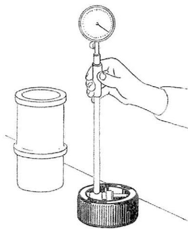
CALIBRO per azzerare l'alesametro controllo Ø canne cilindri
