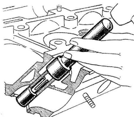
INTRODUTTORE guide valvole nella testa motore
