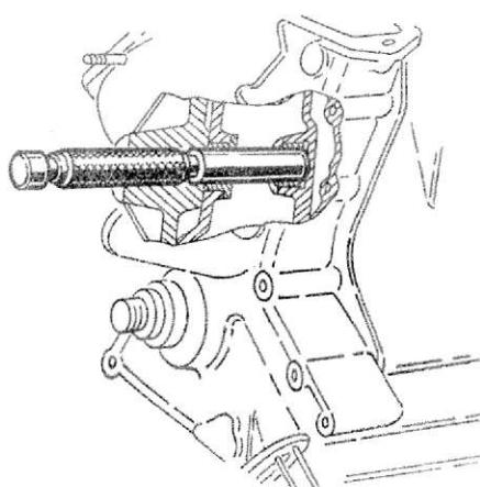
CALIBRO per controllo allineamento boccole ingranaggio rinvio
