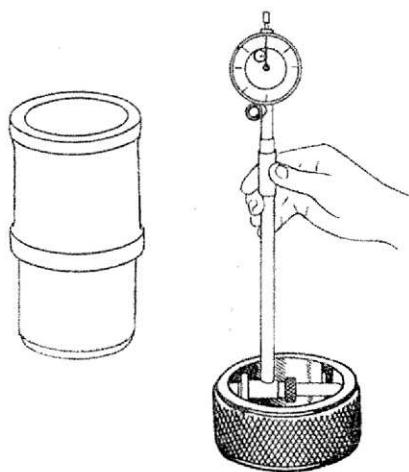
CALIBRO per azzerare l'alesametro controllo Ø canne cilindri
