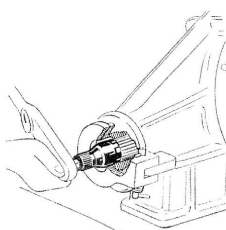
**CHIAVE** per ghiera bloccaggio forcella di trasmissione sul pignone
