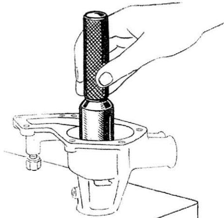
**INTRODUTTORE** anello di tenuta nel corpo pompa acqua
