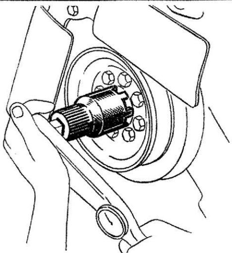
**CHIAVE per bloccaggio ghiera della puleggia sull'albero motore**
