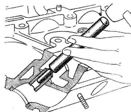
ESTRATTORE guide valvole dalla testa motore
