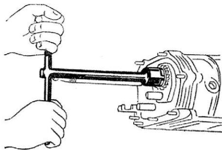
**CHIAVE** per bloccaggio ghiera posteriore dell'albero secondario
