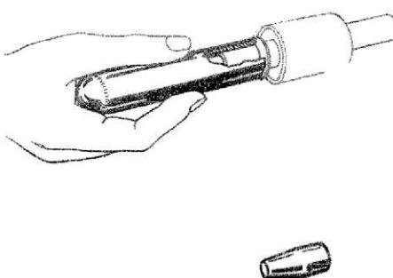
INTRODUTTORE del centrifugatore sull'alberino della pompa acqua
