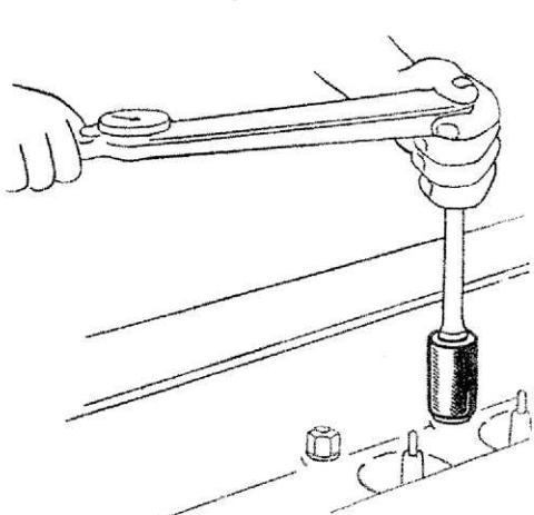
**CHIAVE per bloccaggio dadi della testa motore**
