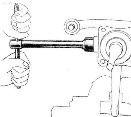
**CHIAVE** per svitare tappi di lubrificazione perni dei fusi a snodo
