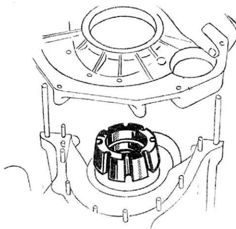
**GUIDA** per montare il paraolio sull'albero motore
