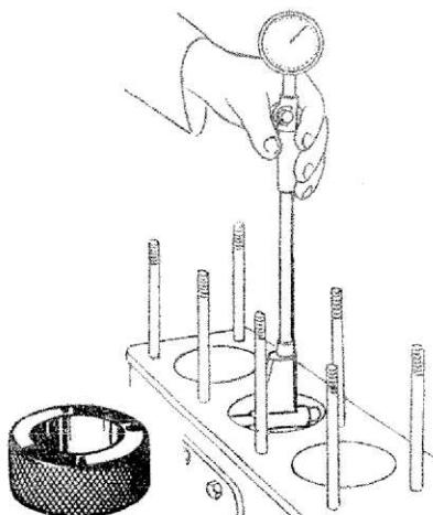
**CALIBRO per azzerare l'alesametro per controllo Ø canne cilindri**
