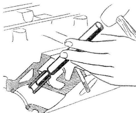
**ESTRATTORE** guide valvole dalla testa motore
