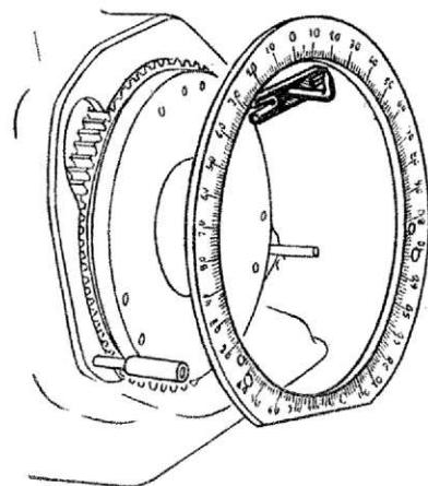
INDICE da fissare sul volano (da impiegarsi con il goniometro C6.0111)
