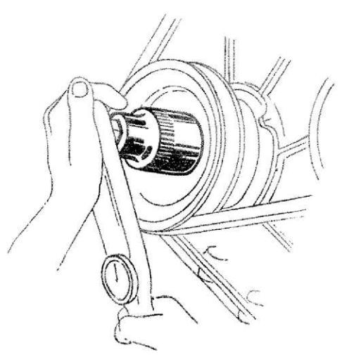
**CHIAVE per bloccaggio dado della puleggia sull'albero motore**
