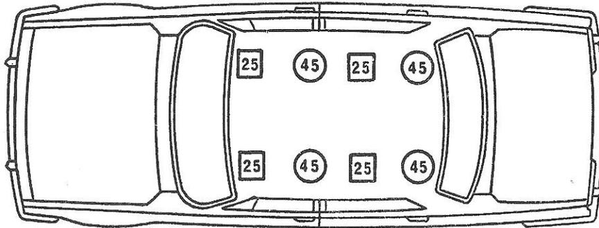
Distance des bras inférieurs de suspension avant par rapport à un plan horizontal de repérage
