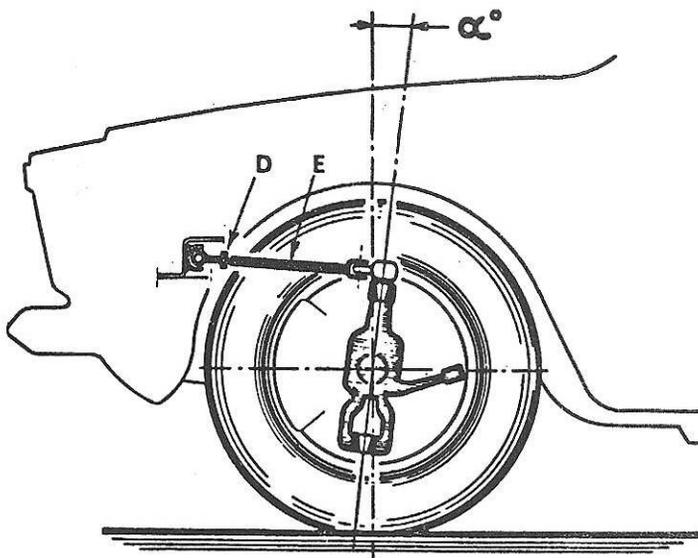
La différence de chasse entre la roue droite et la gauche ne doit dépasser en aucun cas  $0^{\circ}20'$ .
