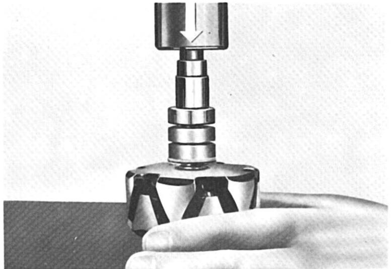
Montare con la pressa a mano il supporto lato comando sul rotore. Curare la pulizia della base di appoggio, affinché non abbiano a penetrare particelle estranee nel cuscinetto a sfere.
