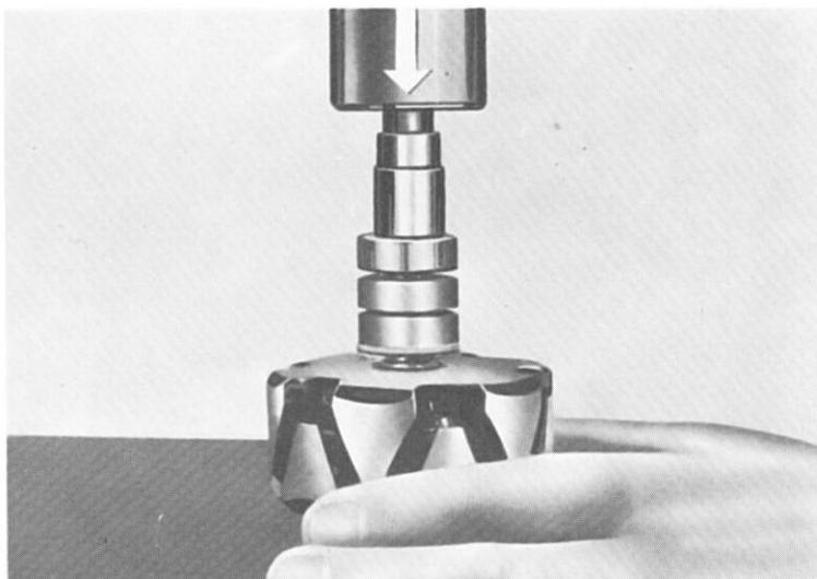
Mit Handpresse Antriebslager auf Rotor aufpressen. Auf saubere Unterlage achten, damit kein Schmutz in Kugellager eindringt.
