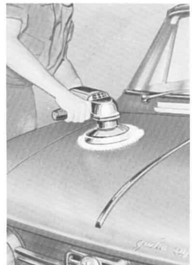
Maschine parallel zur Oberfläche führen,
