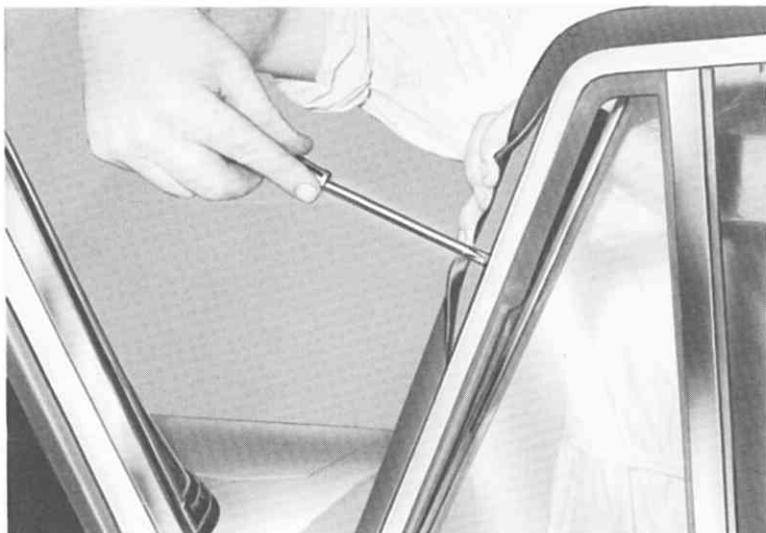
Gummidichtung anheben und darunter befindliche Scharnierschraube des Ausstellfensters lösen.
