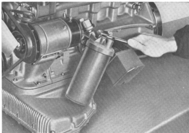
Sostituire la cartuccia avendo cura di lavare il contenitore con benzina ed asciugandolo poi con aria compressa.
